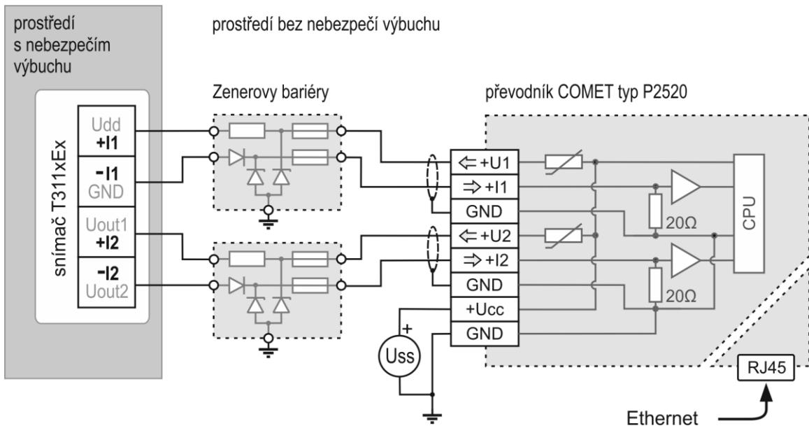
**Příklad připojení snímače řady T311xEx ke vstupům měřící a záznamové ústředny COMET typ MS55D pomocí dvou Zenerových bariér typ MM 7087+ z nabídky fy MM GROUP.**
