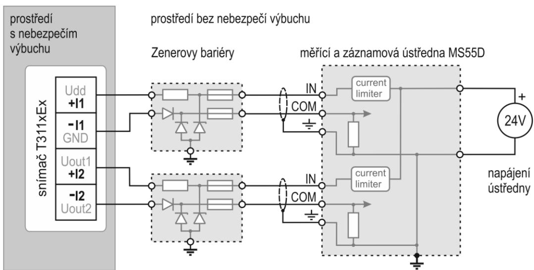
**Příklad připojení snímače řady T311xEx ke vstupům měřící a záznamové ústředny COMET typ MS6 pomocí dvou Zenerových bariér typ MM 7087+ z nabídky fy MM GROUP.**
