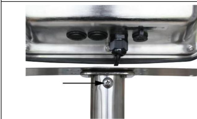
Mit der Schraube des Adapters Anzeigegerät am Stativ fixieren.
