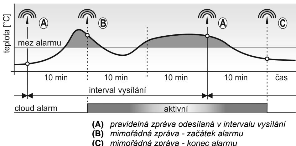
Ani krátkodobý alarm (tj. s dobou trvání 1 až 10 min) nebude ztracen – informace bude odeslána nejpozději do 10 min i když už je aktuálně alarm ukončen. Snímač v alarmové zprávě odešle maximální hodnotu naměřenou v průběhu trvání alarmu.
