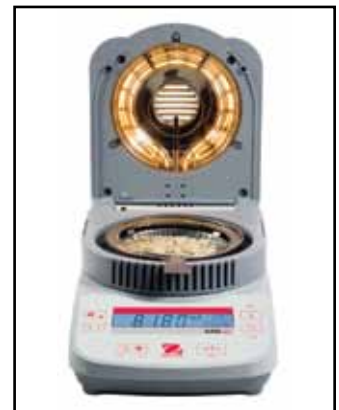
Model OHAUS MB23 se dodává s infračerveným konvenčním ohřevem, dokud MB25 používá halogenovou ohřevu.
