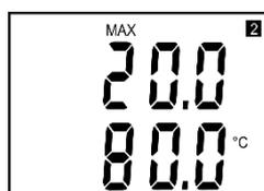
Na závěr se na LCD displeji zobrazí typ veličiny přiřazené 2. kanálu (zde „°C“ = teplota, „2“ = 2. kanál). Na dolním řádku se objeví hodnota měřené veličiny pro výstupní proud 20 mA (zde 80 °C).
