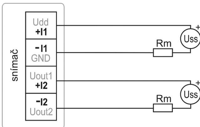
hodnota odporu smyčky  $R_c = R_m + \text{odpor vodičů}$  musí splňovat podmínku  $R_c[\Omega] < 40 \times U_{ss}[V] - 360$
