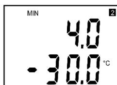
Dále se na LCD displeji zobrazí typ veličiny přiřazené 2. kanálu (zde „°C“ = teplota, „2“ = 2. kanál). Na dolním řádku se objeví hodnota měřené veličiny pro výstupní proud 4 mA (zde -30 °C).
