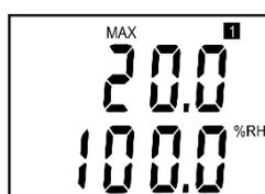
Po dalším stisku tlačítka se na LCD displeji zobrazí typ veličiny přiřazené 1. kanálu (zde „%RH“ = relativní vlhkost, „1“ = 1. kanál). Na dolním řádku se objeví hodnota měřené veličiny pro výstupní proud 20 mA (zde 100 %RH).
