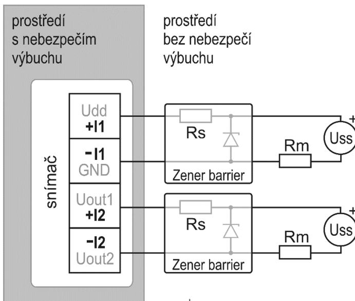
hodnota odporu smyčky  $R_c = R_s + R_m + \text{odpor vodičů}$  musí splňovat podmínku  $R_c[\Omega] < 40 \times U_{ss}[V] - 360$
