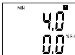
Na LCD displeji se zobrazí typ veličiny přiřazené 1. kanálu (zde „%RH“ = relativní vlhkost, „1“ = 1. kanál). Na dolním řádku se objeví hodnota měřené veličiny pro výstupní proud 4 mA (zde 0 %RH).
