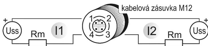
hodnota odporu smyčky  **$R_c = R_m + \text{odpor vodičů}$**  musí splňovat podmínku  **$R_c[\Omega] < 40 \times U_{ss}[V] - 360$**
