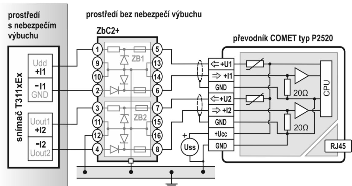
**Upozornění:** hodnota napájecího napětí +Uss nesmí překročit hodnotu maximálního povoleného pracovního napětí Zenerovy bariéry (Upmax = 26 V). Použijte stabilizovaný zdroj 24 Vdc z doporučeného příslušenství.
