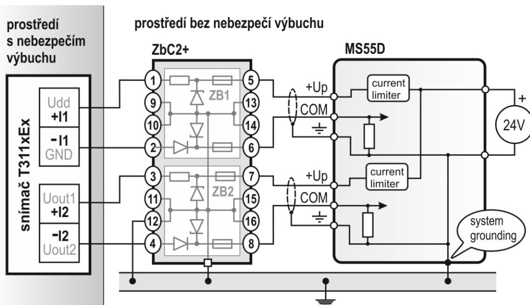
**Upozornění:** hodnota napájecího napětí ústředny nesmí překročit hodnotu maximálního povoleného pracovního napětí zenerovy bariéry ( $U_{pmax} = 26$  V). Použijte stabilizovaný zdroj 24 Vdc z doporučeného příslušenství (pro napájení není vhodný nestabilizovaný zdroj A1759).
