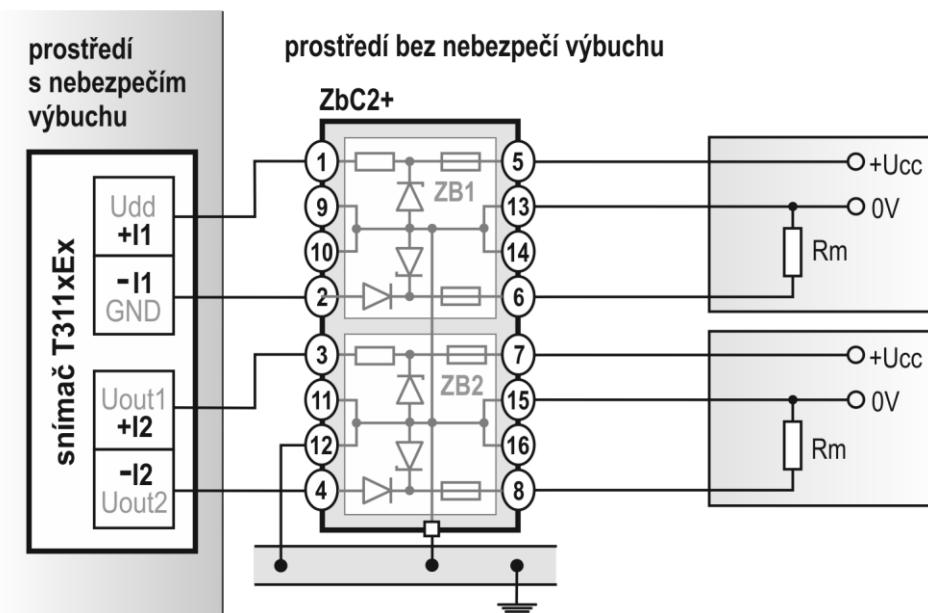
**Upozornění:** hodnota napájecího napětí  $+U_{cc}$  nesmí překročit hodnotu maximálního povoleného pracovního napětí Zenerovy bariéry ( $U_{max} = 26$  V)
