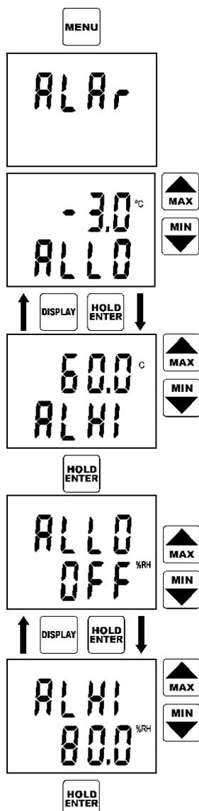
upozorňovat rovněž přerušovaným akustickým signálem, je-li to povoleno nastavením položky menu AUDI na "On" (způsob nastavení viz výše). Aktivace alarmů každé jednotlivé veličiny může být zakázána nastavením dolní meze alarmu příslušné veličiny na její maximální nastavitelnou hodnotu, což je indikováno nápisem OFF místo číselné hodnoty. Hodnota horní meze téhož alarmu je pak lhostejná.
