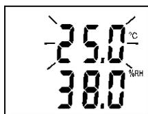
Pro každou veličinu lze nastavit dolní a horní mez, jejichž překročení je indikováno blikáním hodnoty příslušné veličiny na displeji. Byl-li alarm příslušné veličiny nově zjištěn (tzn. byl neaktivní při předchozím měření), přepne se displej navíc do takového zobrazovacího režimu, aby hodnota měřené veličiny, jíž se alarm týká, byla na displeji viditelná. Je-li aktivní alarm alespoň jedné veličiny, může přístroj na tuto skutečnost
