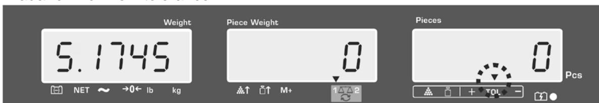
Zobrazení ukazatele tolerance ▼, pokud se hmotnost váženého materiálu nachází nad zadanou tolerancí:
