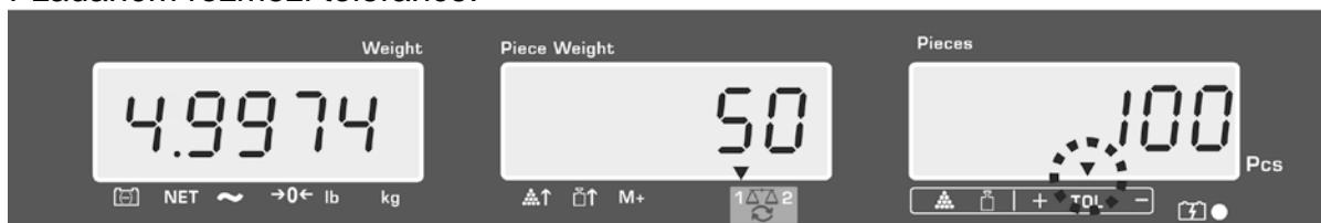
Zobrazení ukazatele tolerance ▼, pokud se hmotnost váženého materiálu nachází nad zadanou tolerancí:
